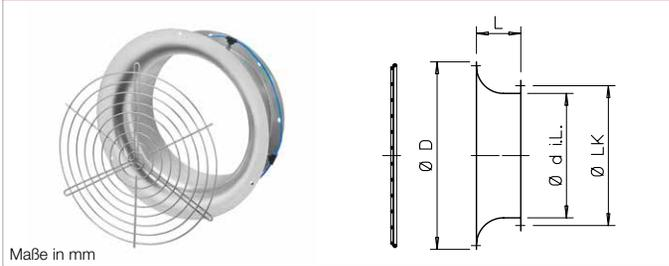
■ **Ansaugdüse mit Schutzgitter** und großem Einlauffradius. Aus Stahlblech gedrückt, feuerverzinkt. Anschlussseitig mit Flansch nach DIN 24155, Bl. 2. Schutzgitter zur saugseitigen Abdeckung,
