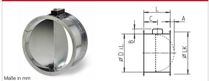
■ **Motorbetätigte Rohrverschlussklappe**<sup>1)</sup> wie RVS, jedoch horizontal und vertikal in jede Richtung einbaubar und mit angebaurem Federrückstell-Motor (außerhalb Luftstrom). Elektr. Ansteuerung parallel mit Ventilator; Kabellänge 0,9 m, stromlos geschlossen.
