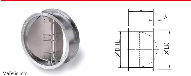
■ **Selbsttätige Rohrverschlussklappe mit Federrückstellung**<sup>1)</sup> Horizontal in jede Richtung, vertikal mit Durchströmung von unten nach oben einbaubar. Klappenöffnung in Strömungsrichtung; automatische Funktion durch Ventilatorbetrieb.
